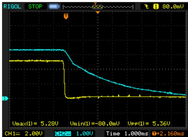
3V 5V 待机失去公共点电压掉电，时基 100MS
