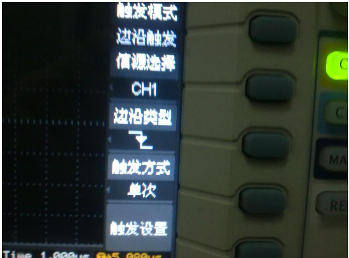
**边沿类型**，电压从低往上升有效的用上升沿，电压从亮往下掉有效的用下降沿，测电压一般用上升沿即可，信源选择 **CH1**
