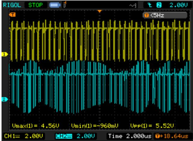
L P C 总线不正常波型，蓝线 A D 1，此时 S M B U S 没有读内存波
