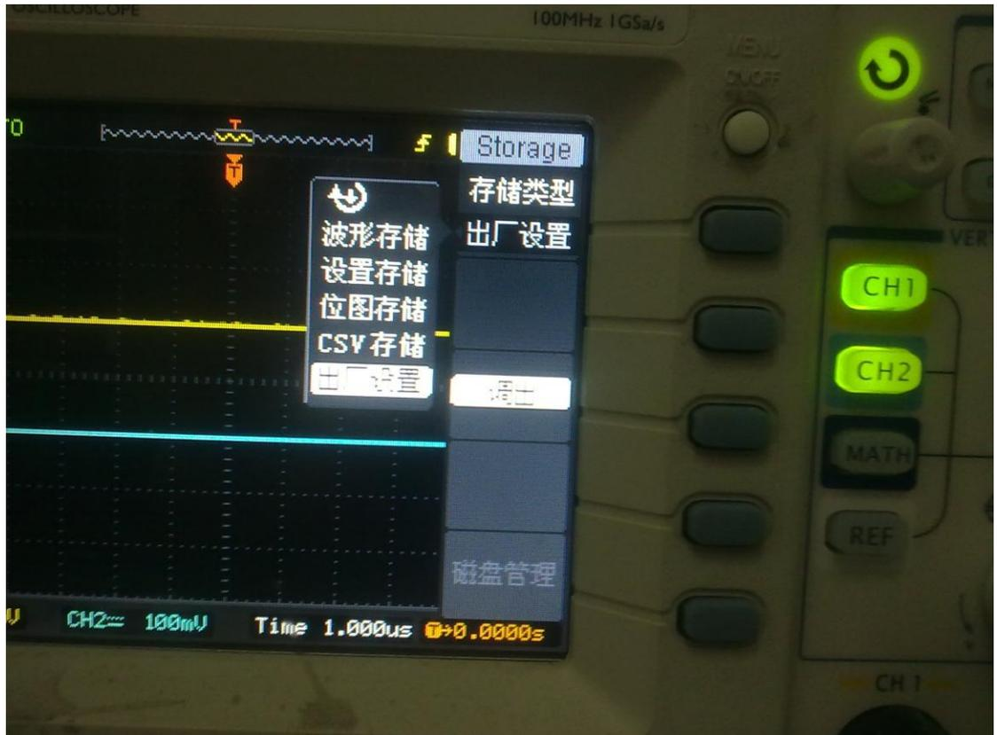
调出后示波器里头的探头比例会变成 1X, 分别把 CH1 和 CH2 都调成 10X 就行, 其他的调节应该根据被测的信号是什么才能做决定, 一般示波器半年要自校正一次, 或刚买回来的也可先自校正一次, 按下 Utilityj 键, 屏幕右边会显示相应的信息, 按向下箭头方向, 翻到第三页, 就可以看到自校正的字样了
