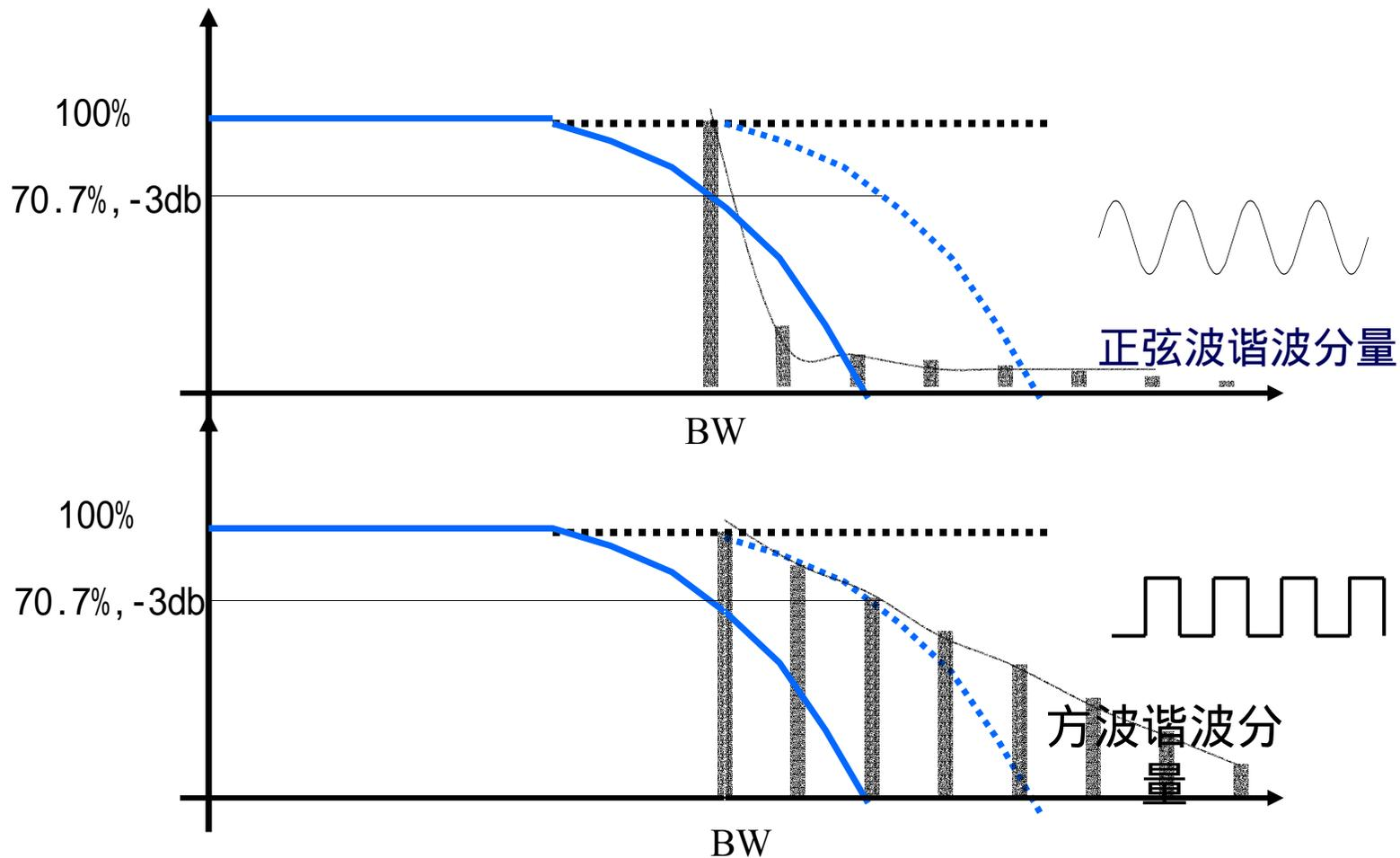
注意：示波器带宽或上升时间与信号频率或上升时间一样时，会对波形幅度和上升时间产生影响，带来测量误差，如减少测量误差只能提高延伸示波器带宽。
